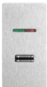
Сканер відбитків, вбудований у дверне полотно Монтаж на дверне полотно, до 150 відбитків, перевірено VDS, розміри: 45 × 75 мм, додатковий варіант для всіх автоматичних замків з електродвигуном
